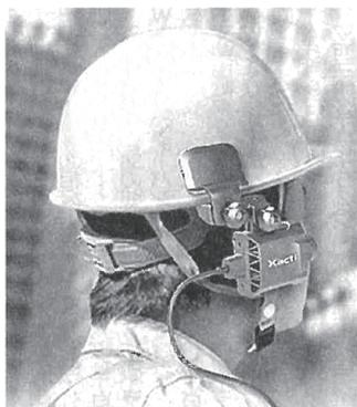
ヘルメットにカメラを取り付けて作業者の視線の映像を伝送できる
